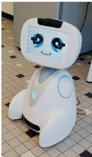
**BUDDY** est un dispositif mobile équipé d'un micro, d'une caméra, de plusieurs capteurs, d'un haut-parleur et d'un écran tactile. Il se recharge à partir d'un adaptateur qui se branche en bas et au dos du dispositif, et il se met en route par pression sur un bouton également situé dans cette zone. La connexion au réseau Wifi, au dispositif pilote et le réglage du volume d'émission sonore se font à partir de l'écran tactile.
